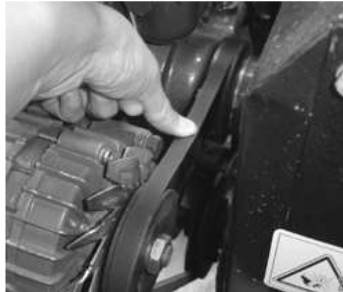
Рис. 5-21 Регулирование натяжения резиновой ленты вентилятора
