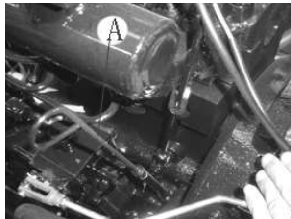
Рис.5-22 Проверка количества масла на поддоне картера двигателя и замена маслом
