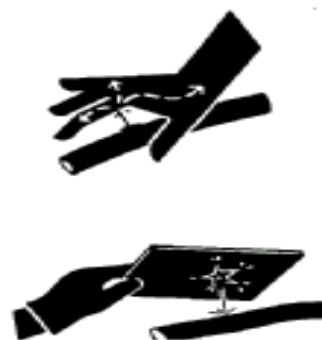
Рис. 1-9. Утечка из гидравлического трубопровода
